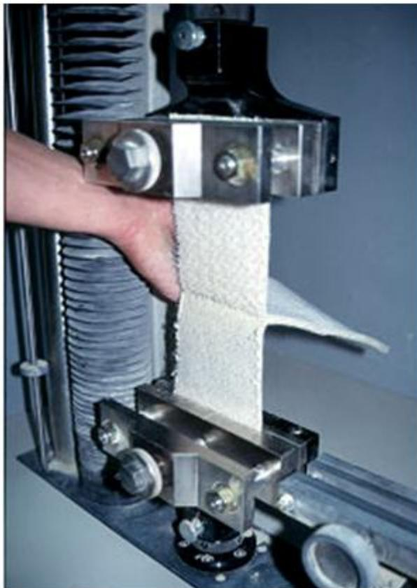
**Рисунок 3 – Установка для испытания бентонитовых матов на разрыв**
