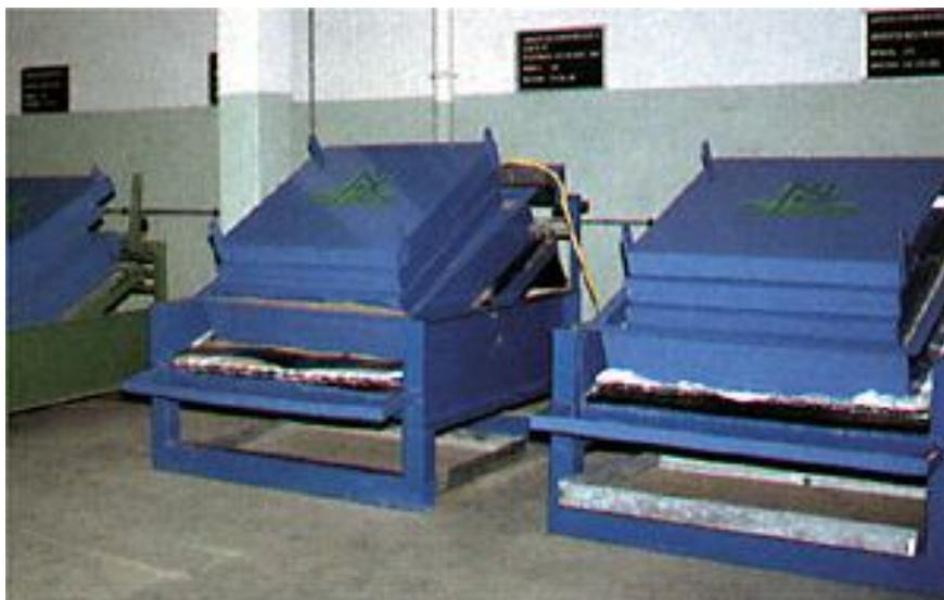
**Рисунок 5 – Испытание «Bentofix» на ползучесть**
