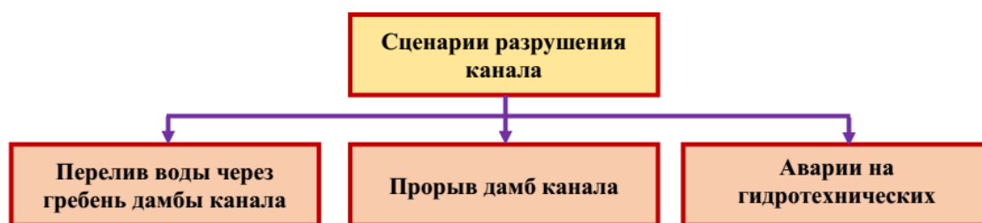
Рис. 4. Возможный сценарий, приводящий к аварии канала
