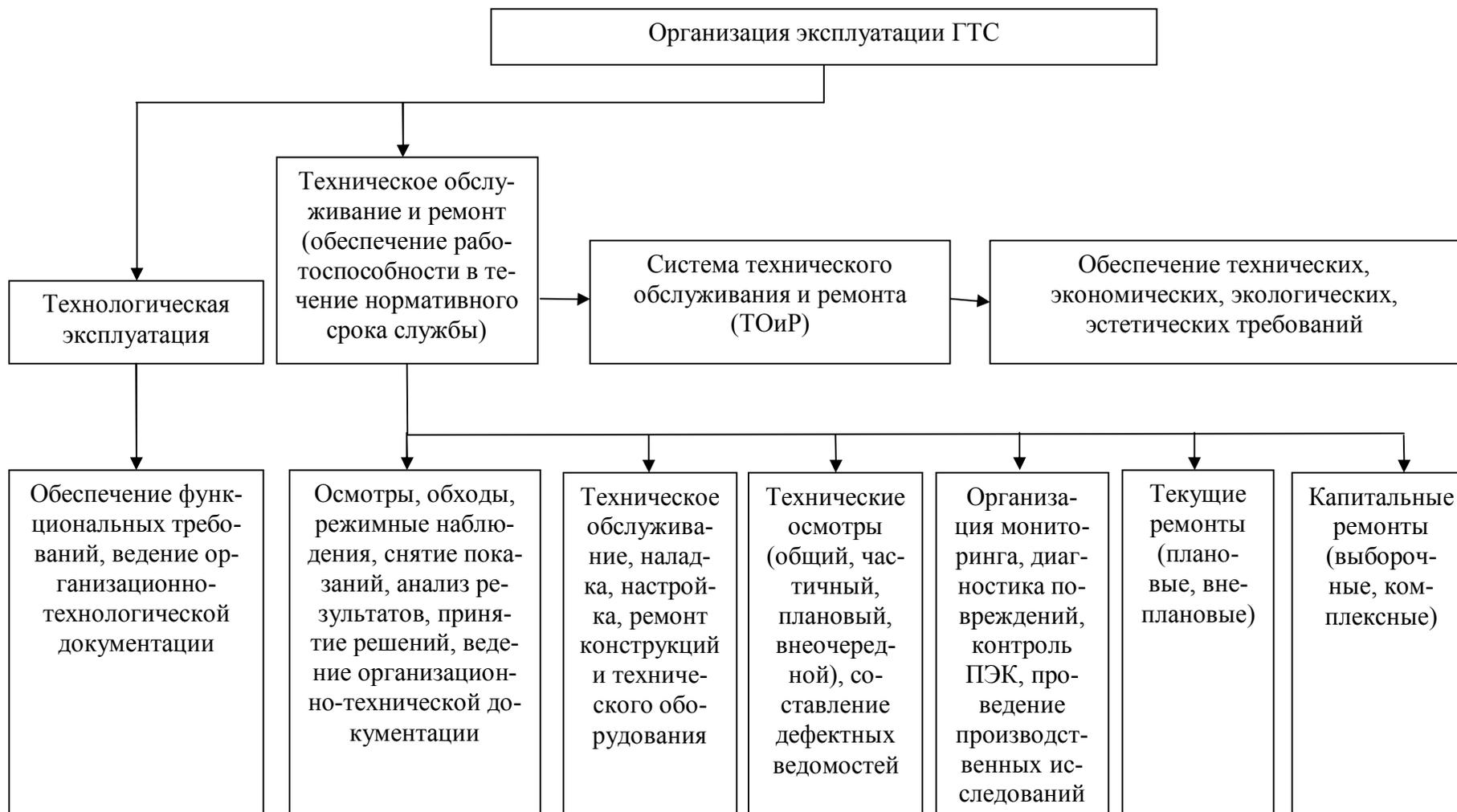
**Рисунок 2 – Схема организации эксплуатации ГТС мелиоративного назначения**
