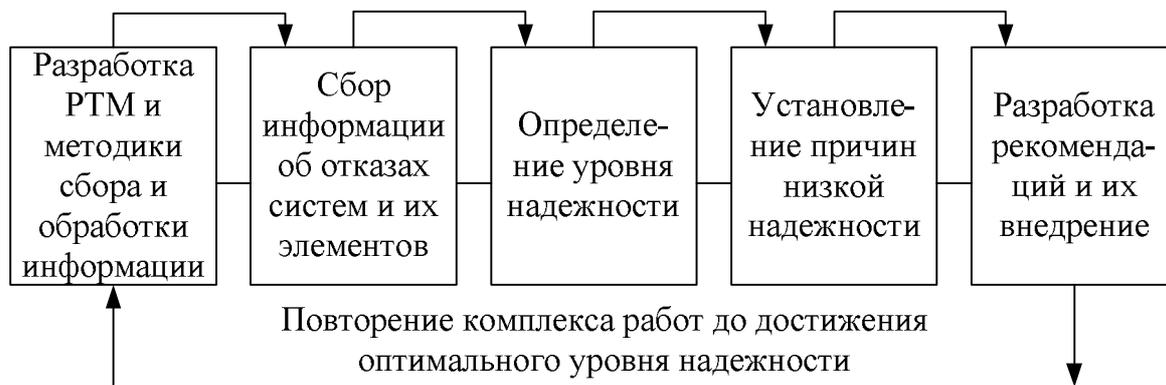
**Рисунок 9 – Структурная схема работ по повышению надежности**
