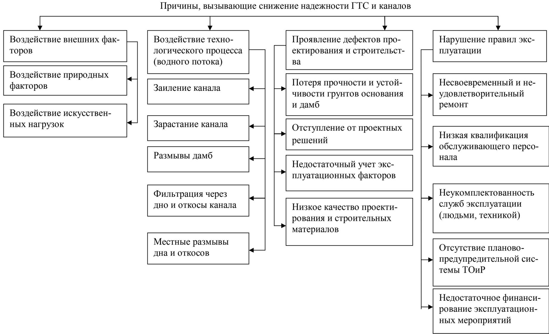
**Рисунок 8 – Причины, вызывающие снижение надежности ГТС и каналов**
