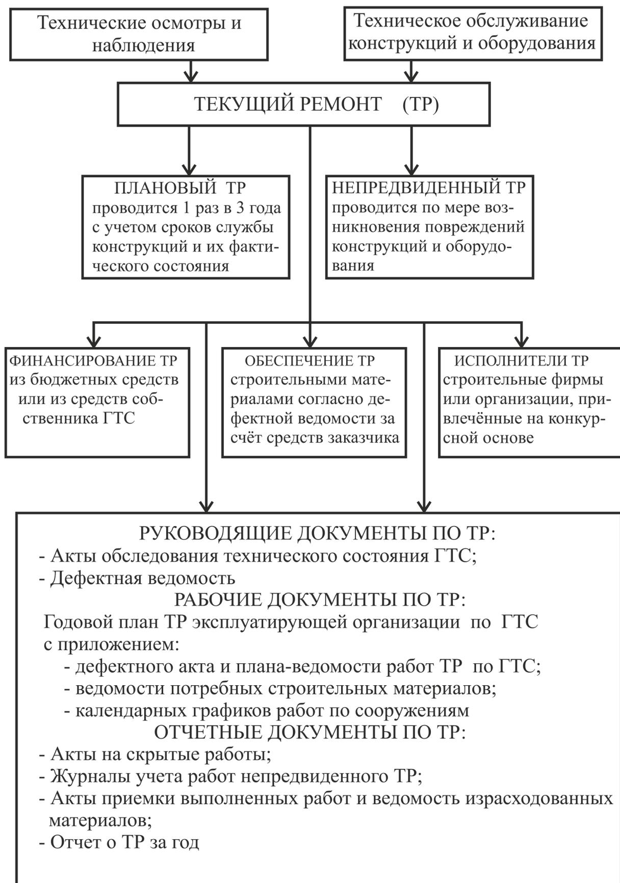
**Рисунок 3 – Схема реализации системы ГОиР при текущем ремонте гидротехнических сооружений**
