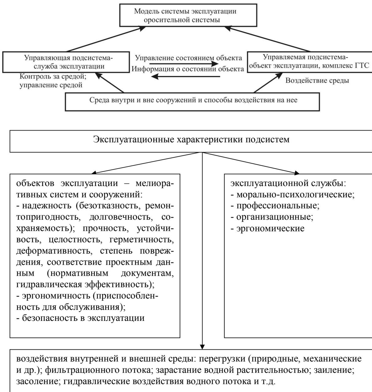
**Рисунок 6 – Модель системы эксплуатации и их эксплуатационные характеристики**
