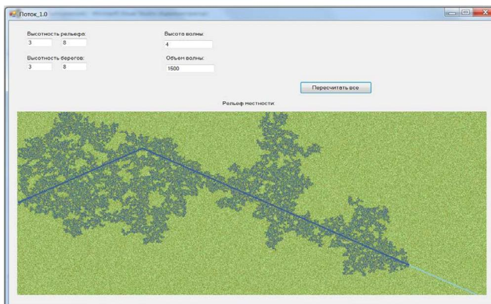
Рисунок 3 - Расчет на тестовом рельефе со случайными высотными отметками, как в первом тестовом случае, а начальная высота волны была больше
