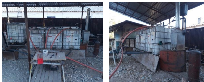
Рисунок 1 – Общий вид трехступенчатого биореактора для производства жидкого органического удобрения
