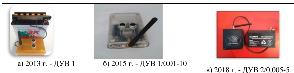
Рисунок 3- Опытные образцы датчиков уровня воды, разработанные в ТОО "КазНИИВХ" в последние годы
