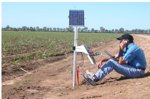
Рисунок 6 – Аппаратура мониторинга влажности почвы с помощью Agritech Solutions Pty
