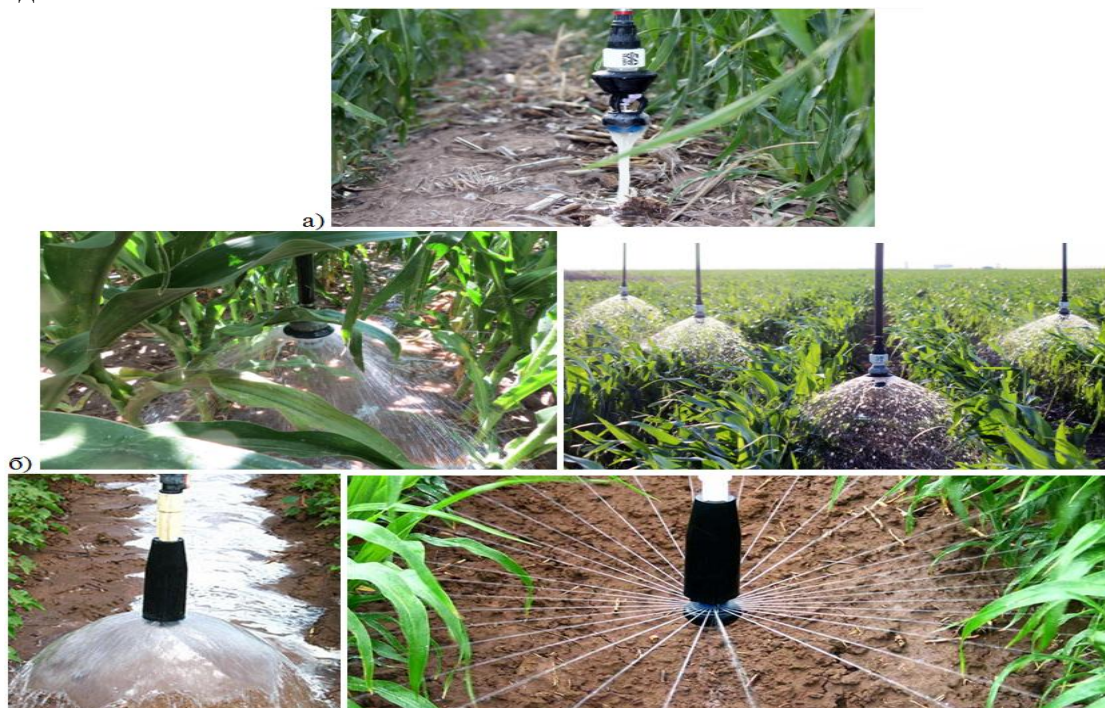
а – барботер LDN LEPA ( Q=61-4168 л/ч; P=0,41-1,03 атм.); б – барботер QUAD SPRAY® ( Q=80-2076 л/ч; P=0,41-0,69 атм.)
