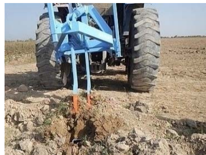
Рис. 4.3.12 Приподнимание кротодренажной машины
