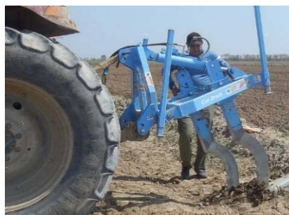
Рис. 4.3.10 Положение ножа во время нарезки
