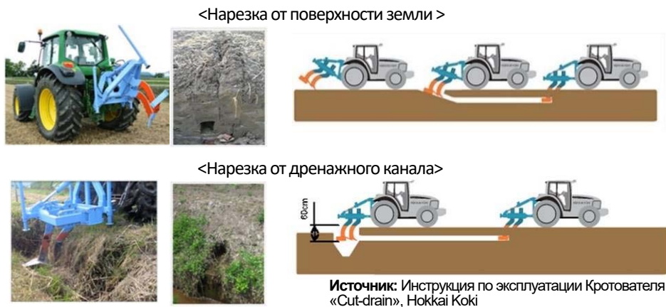
Рис. 4.3.6 Как нарезать кротовую дрину
