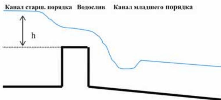
Рис А1.10 Регулятор расхода с пропуском воды поверху
