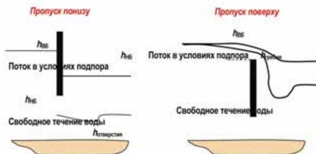
Рис А 1.7 Типы движения потока на сооружениях
