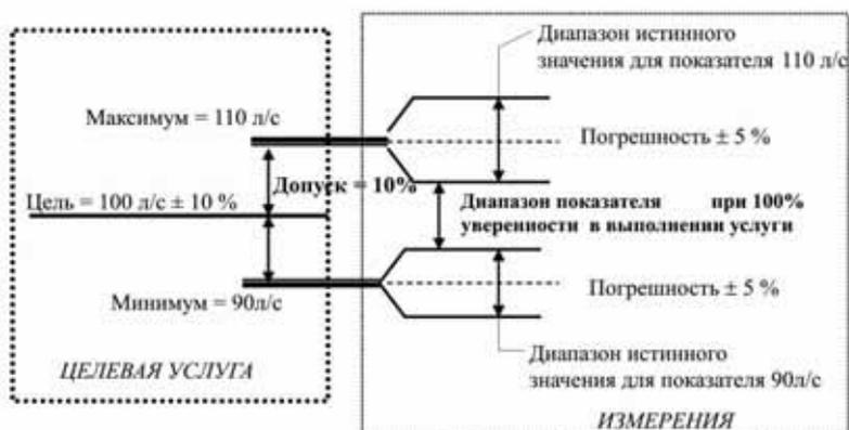
Рис 54 Иллюстрация совместимости допустимого отклонения/погрешности при водоподаче
