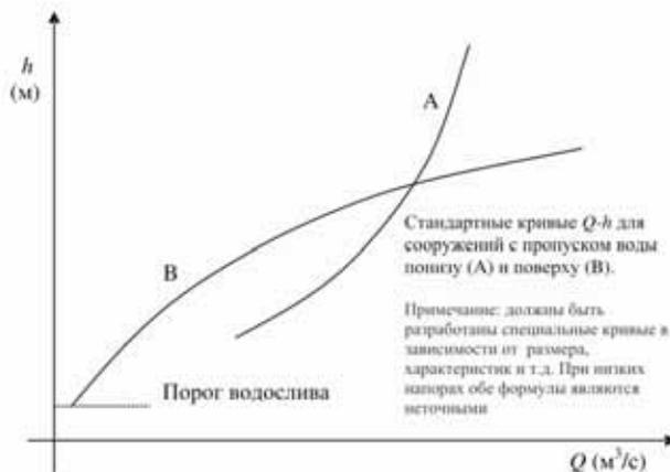
Рис А1.12 Кривые  $Q-h$  для гидротехнических сооружений
