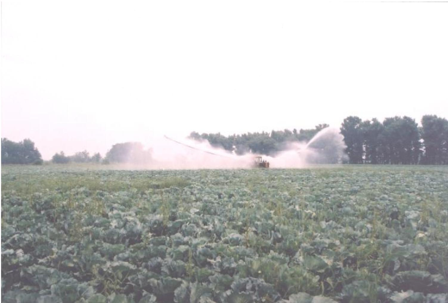
**Рис. 3. Дождевальная машина ДКДФ-1 в работе**
