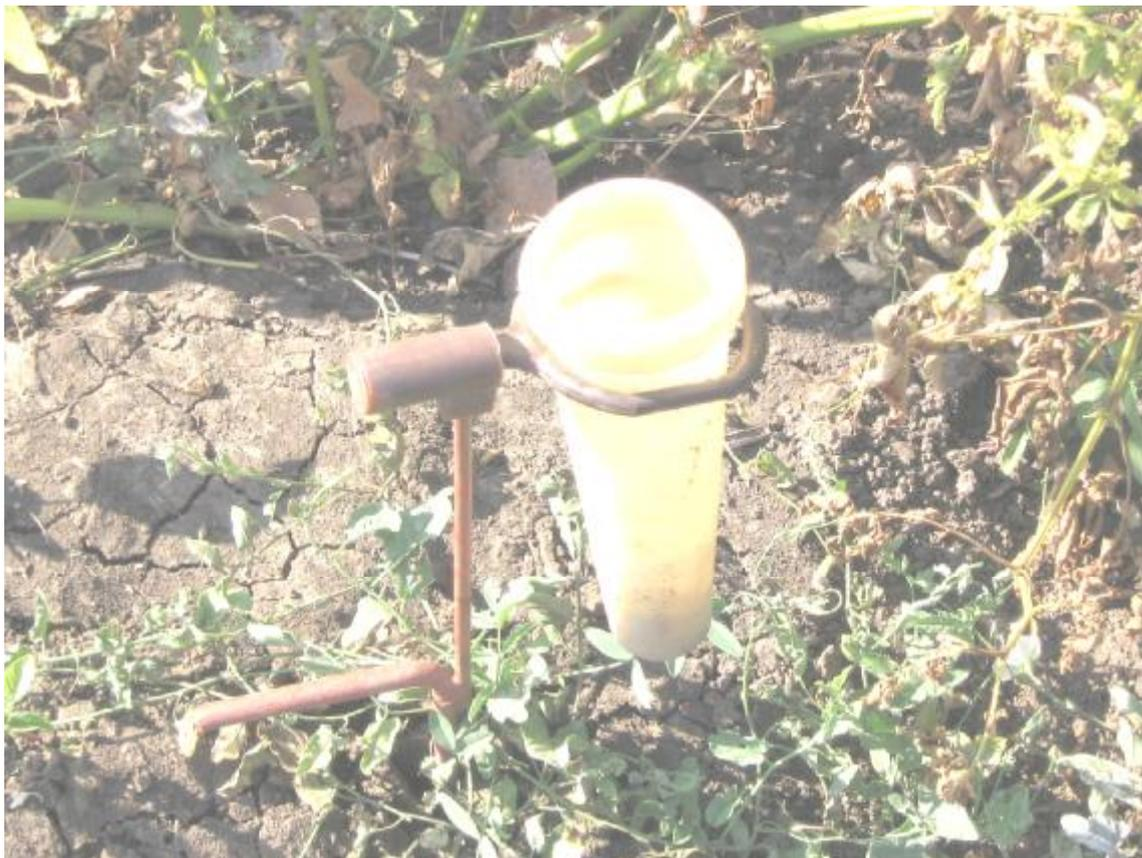
**Рис. 9. Прибор для улавливания дождевых осадков**
