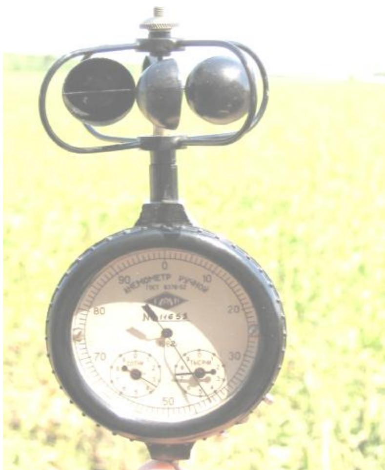
**Рис. 15. Чашечный анемометр**
