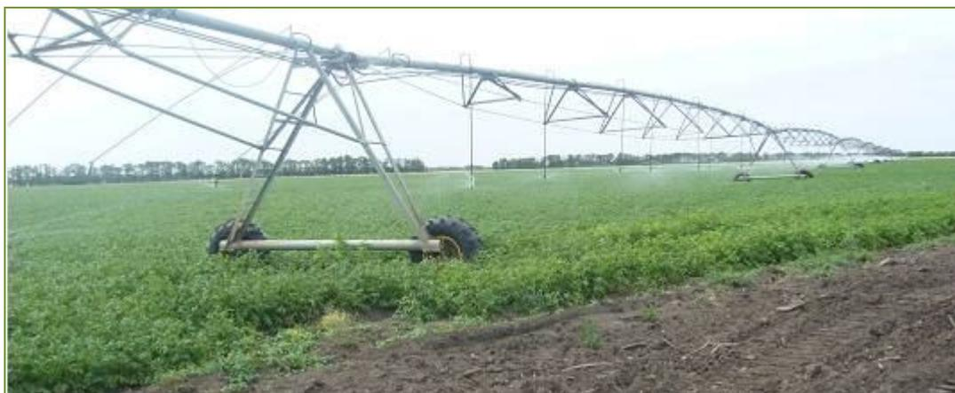
**Рисунок 1 – ДМ фирмы T-L с гидроприводом**
