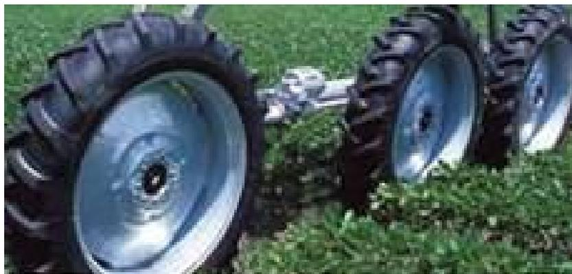
**Рисунок 6 – Трехколесная опорная тележка**
