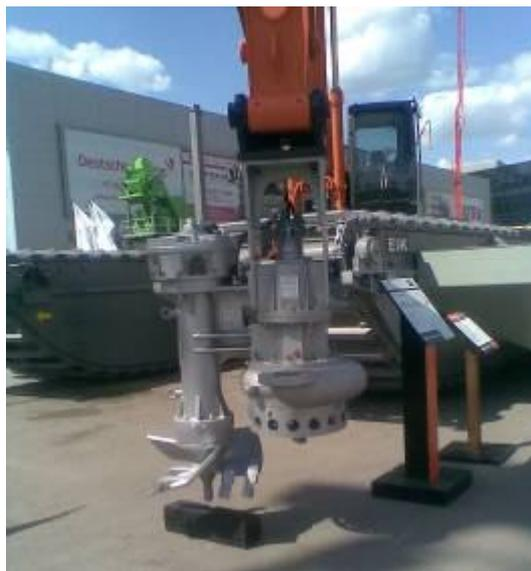
**Рисунок 3 – Экскаватор-амфибия с землесосным оборудованием
