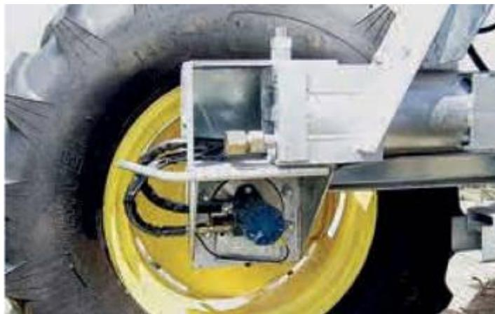
**Рисунок 2 – Гидравлический мотор привода колеса опорной тележки ДМ T-L**
