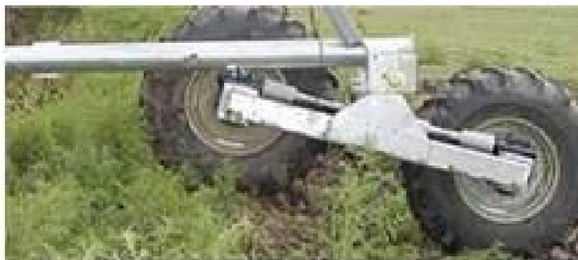
**Рисунок 7 – Шарнирная четырехколесная опорная тележка**
