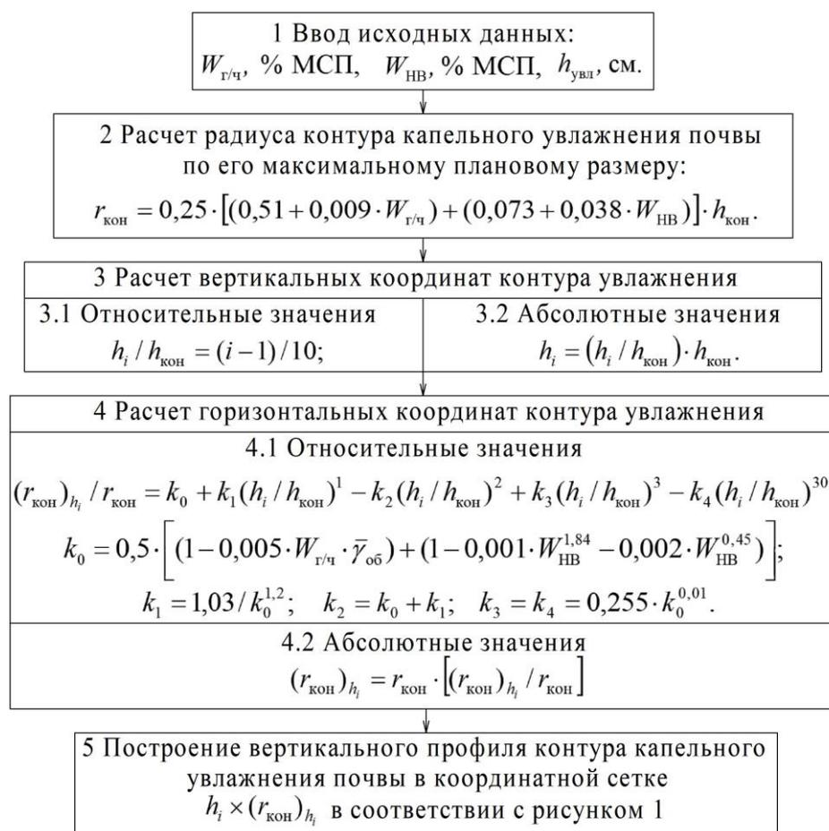
**Рисунок 2 – Схема расчета координат и построения очертания контуров капельного увлажнения почвы**
