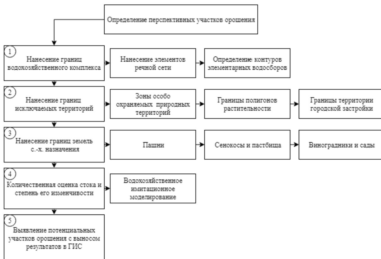
**Рисунок 1 – Блок-схема определения перспективных участков орошения**
