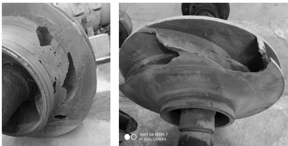
Рисунок 1 – Эрозия рабочих колес насосов типа «Д» из-за кавитации и дисбаланса между рабочим колесом и проточной частью (фото О. Я. Гловацкого, НИИИВП)
