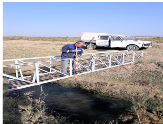
Рисунок 4 - Процесс замера стока коллекторно-дренажных вод
