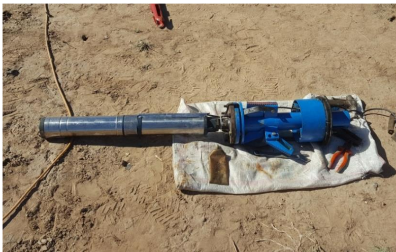
Рисунок 1 – Устройство для откачки подземных вод по обсадной колонне скважины в сборе с погружным насосом
