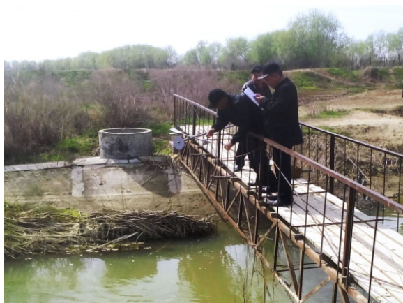
Рисунок 4 - Процесс замера стока коллекторно-дренажных вод
