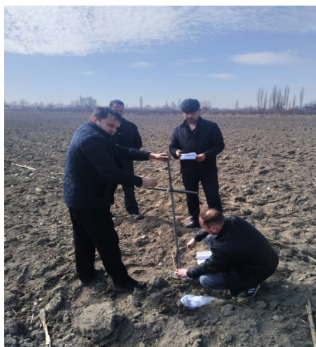
Рисунок 3 - Отбор образцов почвы на химический анализ и отгрузка химического мелиоранта на пилотный участок (ПУ-1) в с. Талас Жамбылской области
