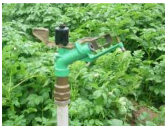
Рис.5.Дождевальный аппарат на стояке
