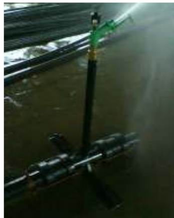
Рис. 6. Патрубок со стойкой, опорой и дождевальным устройством
