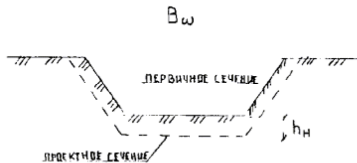
Рис. 1 Поперечное сечение каналов с недобором грунта
