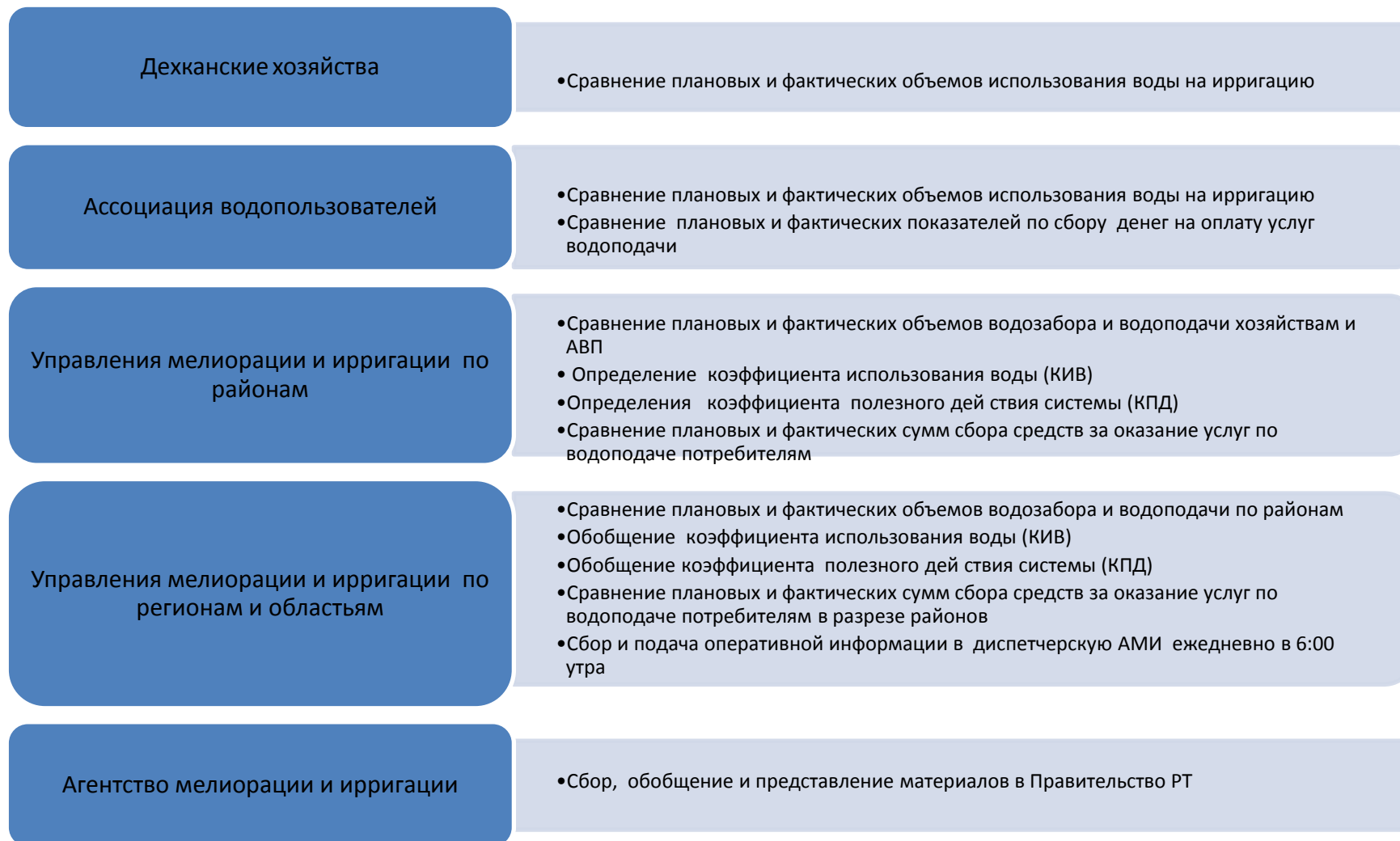
Рис. 1. Схема сбора и передачи информации на различных иерархических уровнях управления водными ресурсами в ирригации.
