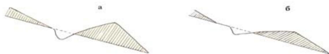
Рис. 3. Полотно ступенчатых террас с обратным (а) и горизонтальным (б) уклоном
