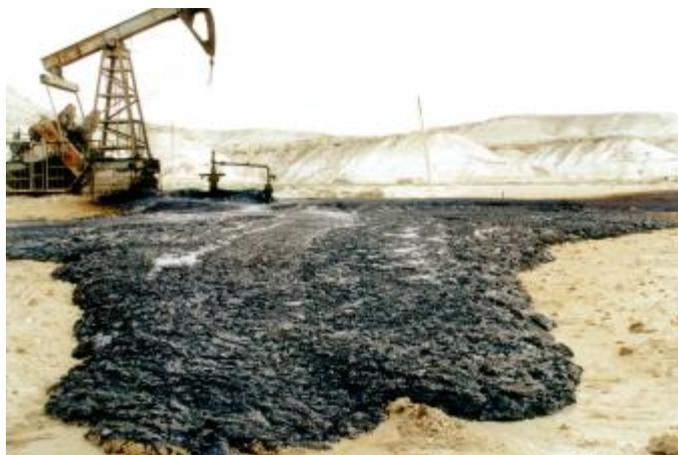
Рис. 1 Нефтяная лужа, образованная при буровых работах
