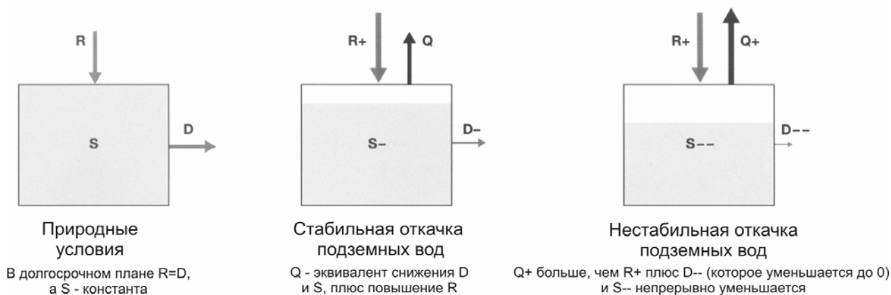
Рис.4. Схематическое действие изъятия воды на баланс ресурсов подземных вод
