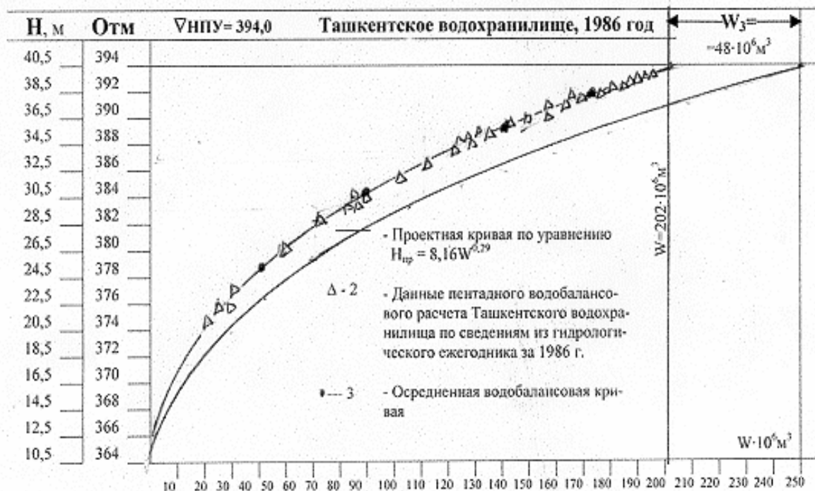
Рис.2 Кривые H = f(W) Ташкентского водохранилища по проекту (1), и данным водобалансового расчета (2), составленной по сведениям из гидрологического ежегодника за 1986 г.
