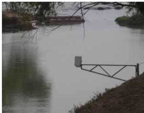
**Рис. 4. Установка датчика уровня воды**
