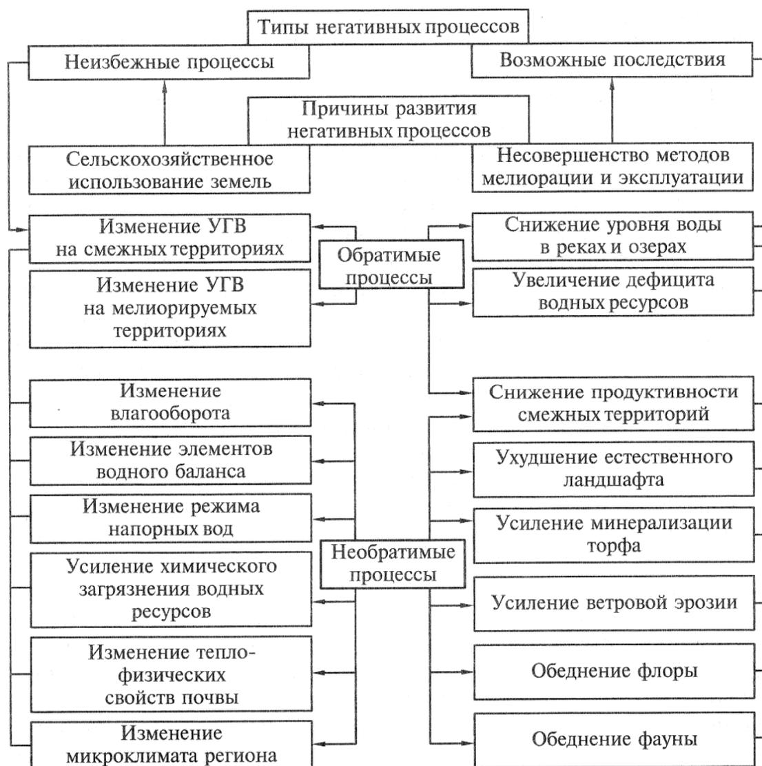
Рис. 1. Схема типизации негативных процессов мелиорации
