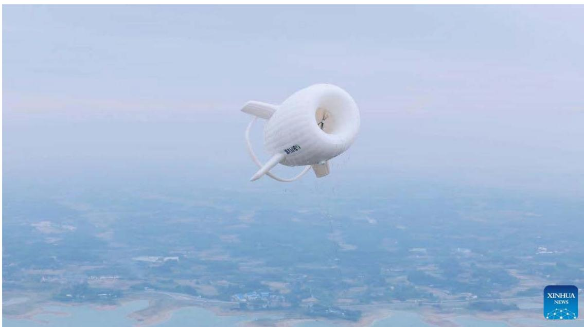
В компании отмечают, что мощность установки эквивалентна традиционной ветряной турбине с диаметром лопастей около 100 м. При этом система способна стабильно работать более 25 лет благодаря внедренным мерам безопасности, включая технологию регулирования давления газа внутри аэростата.
