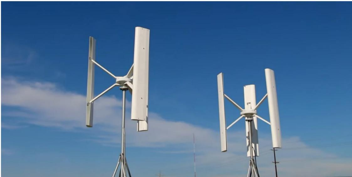
Кроме того, вертикальные турбины при работе испытывают более стабильную нагрузку, что снижает механическое напряжение и потенциально позволяет им прослужить дольше, чем обычные ветрогенераторы.
