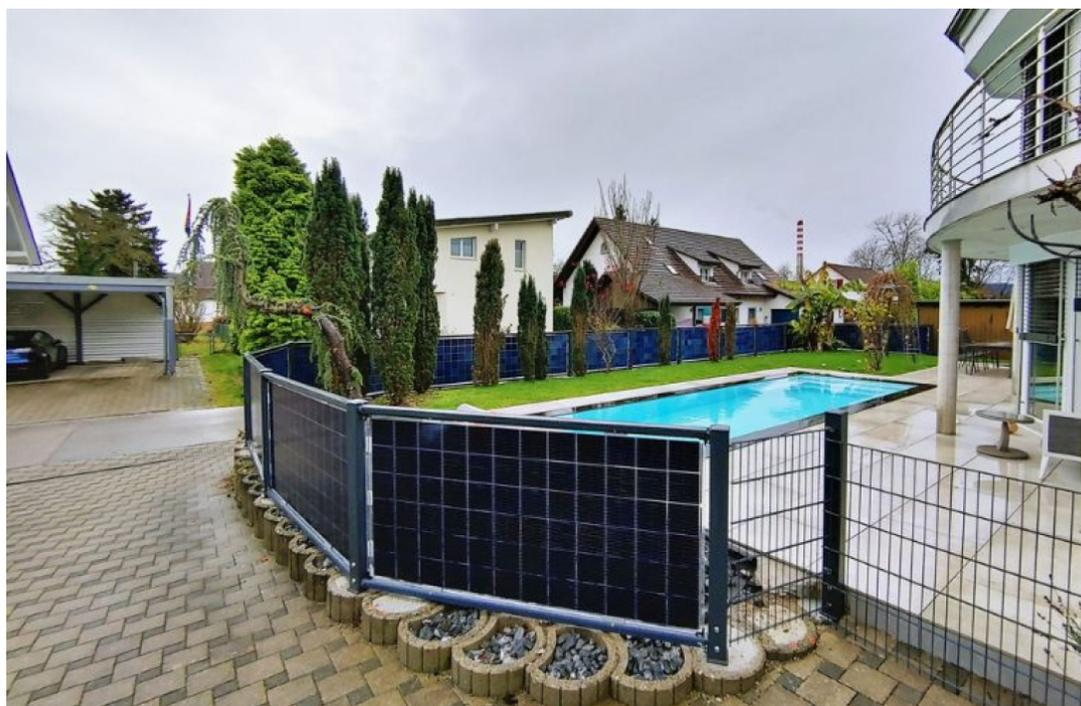
При этом на работу солнечного забора не влияют такие явления, как снег, скопление пыли или опавших листьев. Помимо независимого производства электроэнергии, конструкция может служить ограждением для участка.
