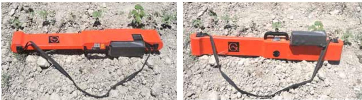
Рисунок 1- Общий вид прибора EM38 в горизонтальном и в вертикальном
