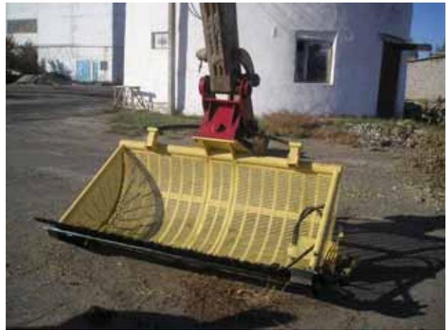
Рис. 2 – Установка нового сменного рабочего органа на экскаватор
