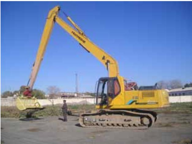
Рис. 1 – Гидравлический экскаватор с навешанным ковшом-косилкой
