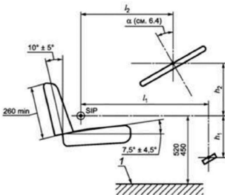
Рисунок 10. Расположение сиденья оператора - вид сбоку
