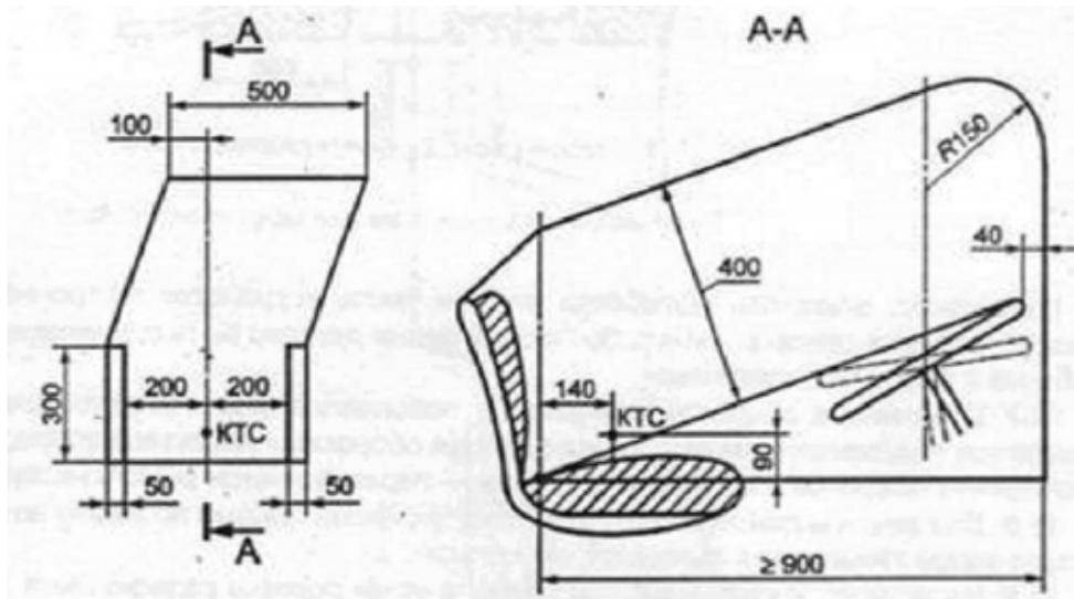
Рисунок 2. Зона свободного пространства при деформации дуги безопасности, установленной впереди центра рулевого колеса
