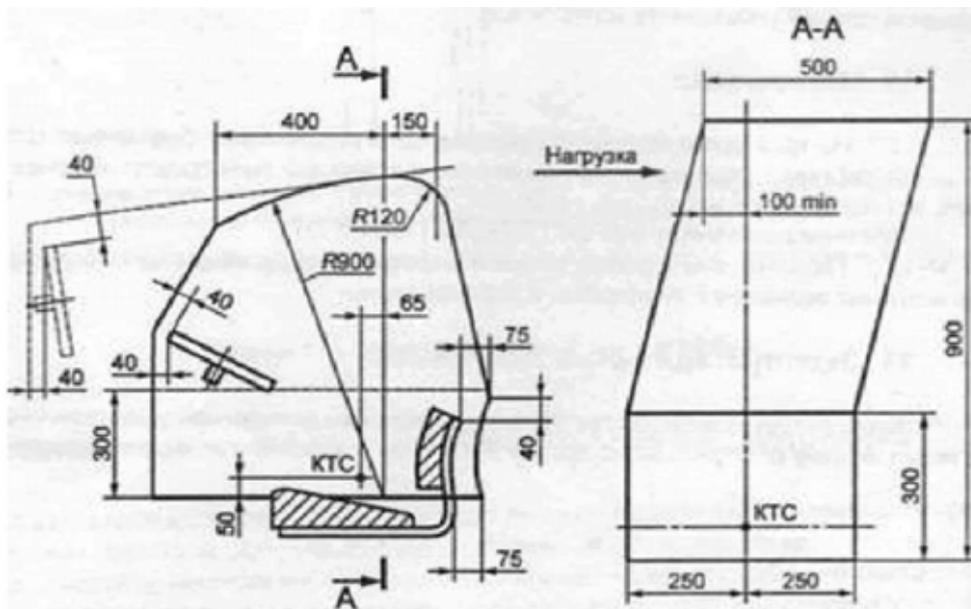
Рисунок 3. Зона свободного пространства при деформации кабины, каркаса и других защитных устройств
