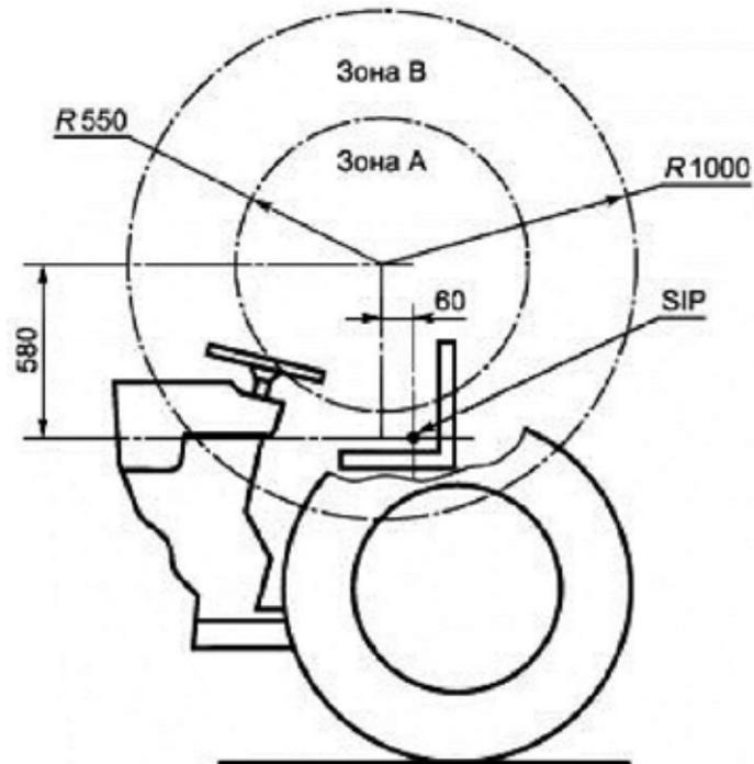
Рисунок 16. Сферические зоны свободного пространства для тракторов и других машин
