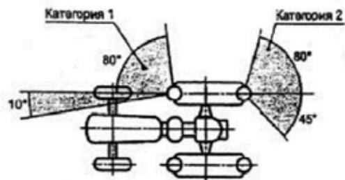
Рисунок 1. Указатели поворота. Геометрическая видимость
