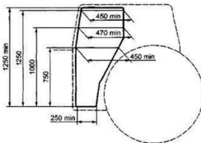
**Рисунок 7. Размеры дверного проема для тракторов**
