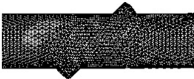
**Рис. 12. Сетка ультразвукового расходомерного узла**
