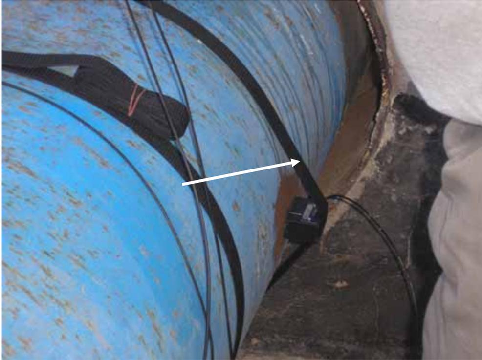
**Ультразвуковые датчики установленные на поверхности
