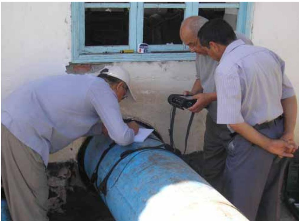
**Процесс измерения расхода воды**
