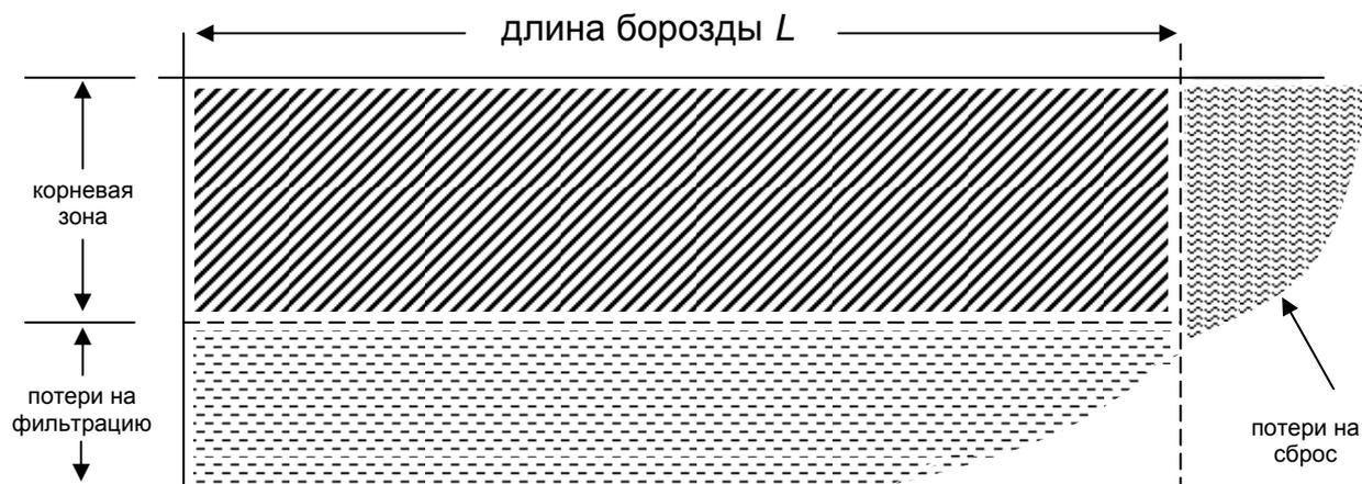
Рис.3 - Пример чрезмерного полива
