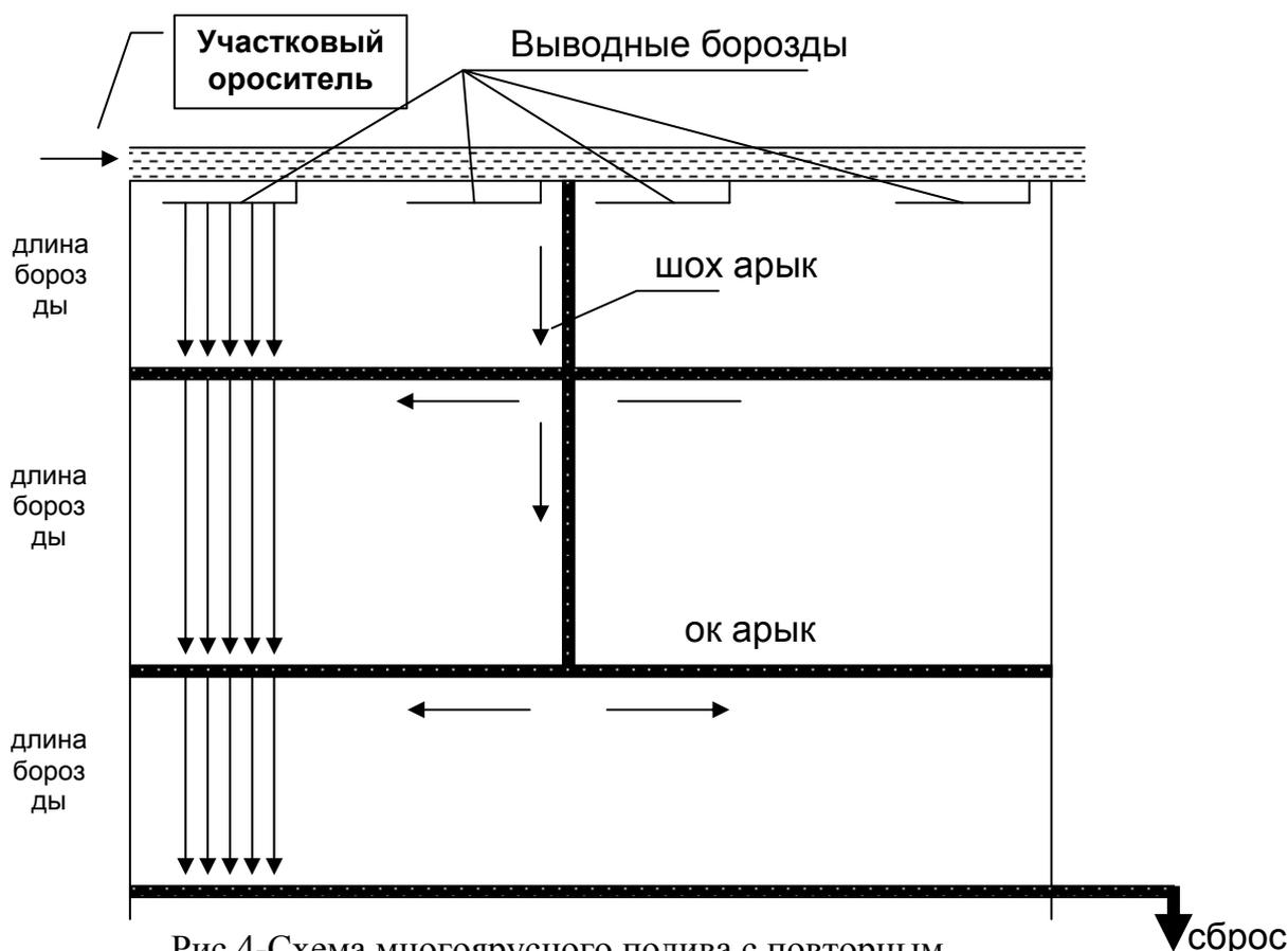
Рис.4-Схема многоярусного полива с повторным использованием сброса
